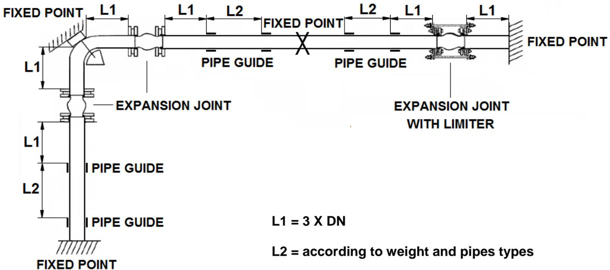
RUBBER EXPANSION JOINT TEGUFLEX® PU GREEN CSM
