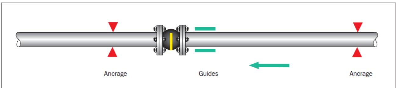
**RUBBER EXPANSION JOINT TEGUFLEX® PU WHITE FOOD NBR**
